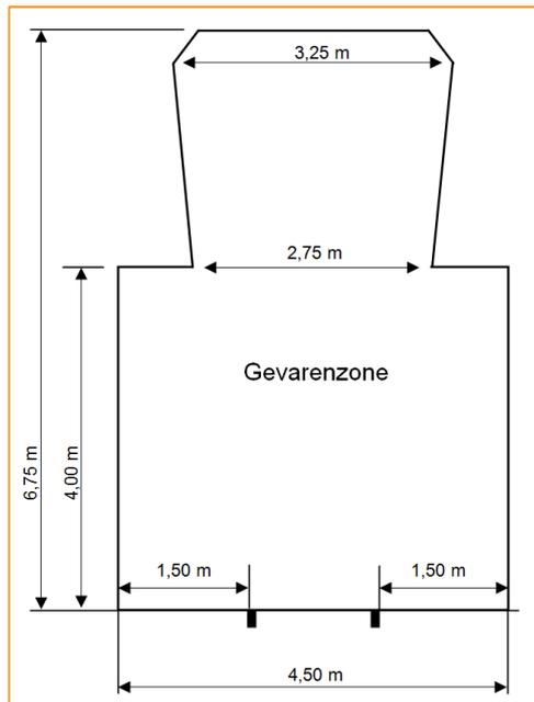
**Figuur 2.** Maximale gevarezone van de tram. Lokaal kan een kleinere gevarezone gelden, zie hiervoor documentatie van de trambaanbeheerder.
