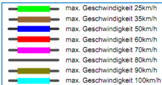
Figuur 8, Kleurcodering in de track lay-out.
